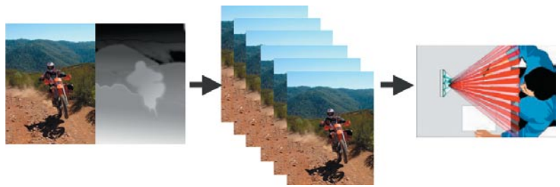
Рис. 3. Трансформация 2D+Z изображения в серию кадров и показ на устройстве объемной визуализации.
