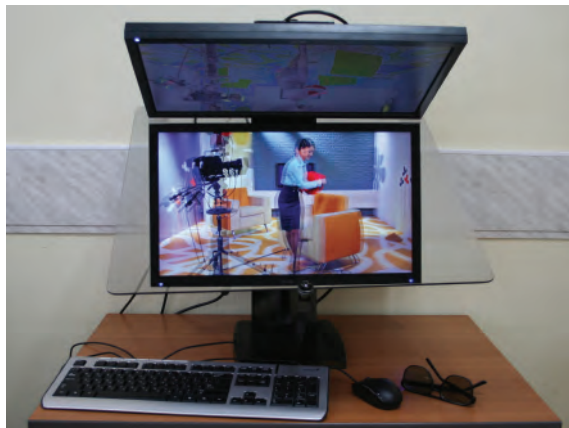
Рис. 2. S3D-дисплей на основе двух мониторов и полупрозрачного зеркала
