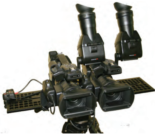
Рис. 4. Стереопара с горизонтальным креплением камер
