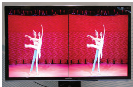
Рис. 3. S3D-видео в формате side-by-side на экране телевизора в 2D-режиме
