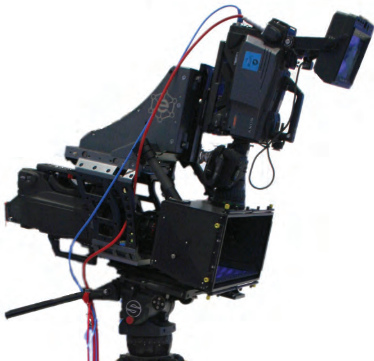
Рис. 5. Стереопара с использованием полупрозрачного зеркала
